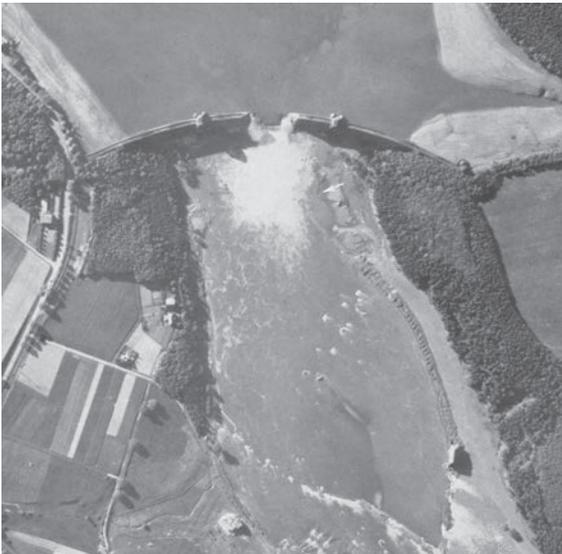
Die verheerendsten Folgen des Angriffs gab es an der Möhnetalsperre: Hier erreichte **eine** der abgeworfenen Rollbomben ihr Ziel und verursachte einen Riss in der Mauer, der sich durch den Druck der ausströmenden Wassermassen rasch zu einer fast 80 Meter breiten Lücke erweiterte.
